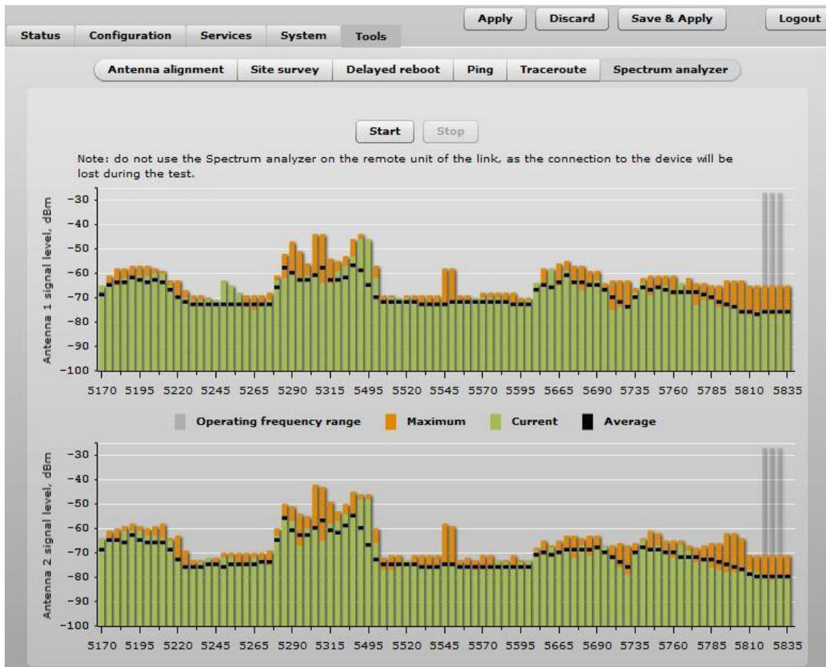
Figura 71 – Resultados de la prueba de análisis de espectro
