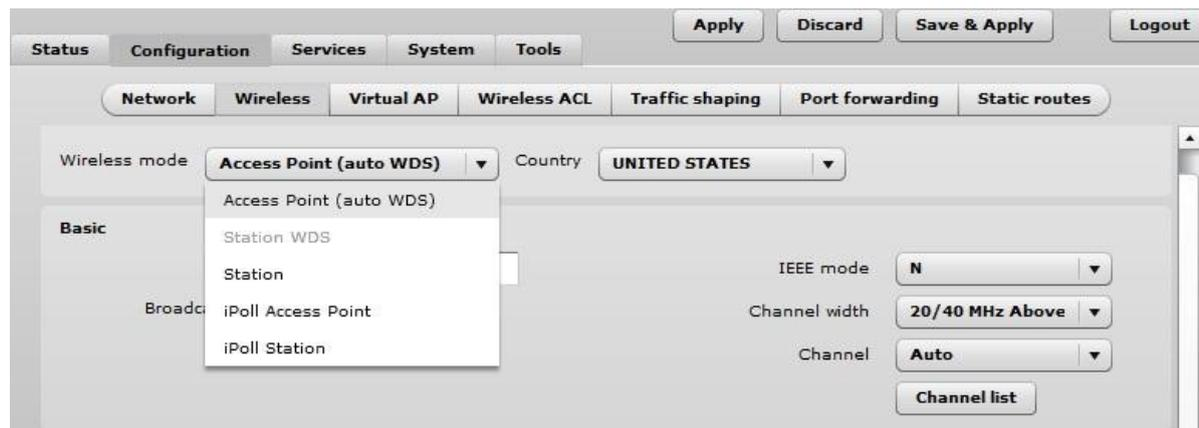
Figura 25 – Modos de operación inalámbrica
