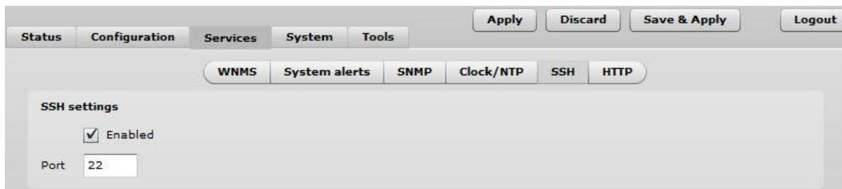
Figura 58 – Configuración SSH
