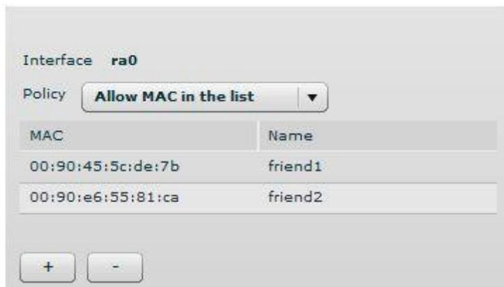
Figura 48 – Configuración de listas de acceso inalámbricas
